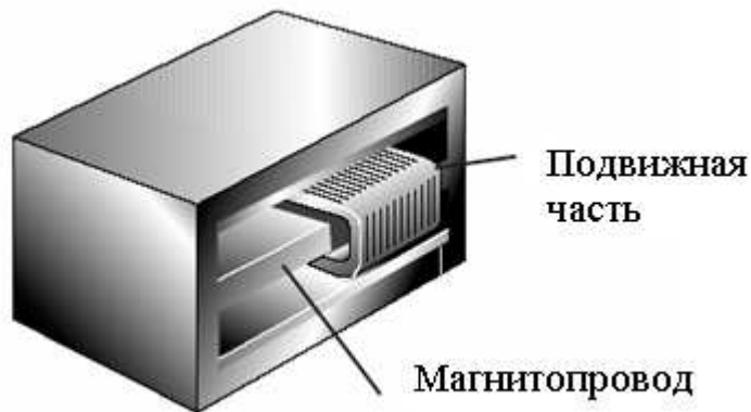
Рис. 4.3. – Принцип построения линейного двигателя
